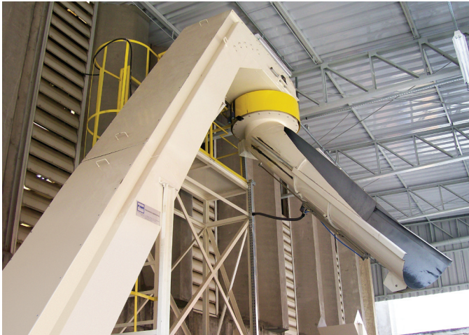
CENTRAL DE TRANSPORTADORES COM CALHA GIRATÓRIA CONVEYOR CENTER WITH TURNING TROUGH
